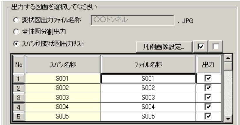
スパン別に出力した図面に凡例画像を併せて出力する場合は、凡例画像設定ボタンをクリックして出力する凡例画像の設定をします。凡例画像として使用できる画像はJPGファイルのみです。
