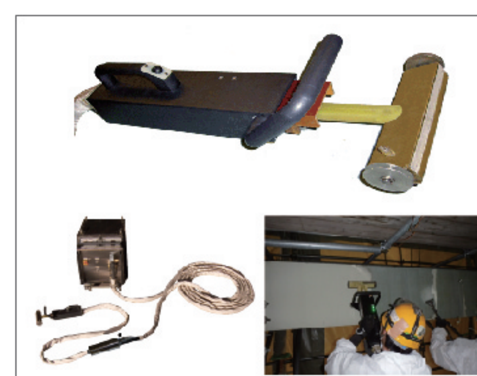
IH式被膜剥離
