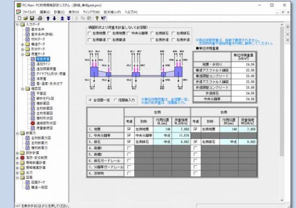
入力データ/荷重データ-橋面荷重
