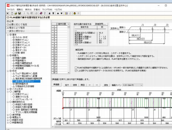
非合成・鋼床版箱桁/形状 - 継手位置
